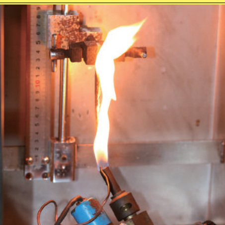
Campione durante il controllo UL94VO
